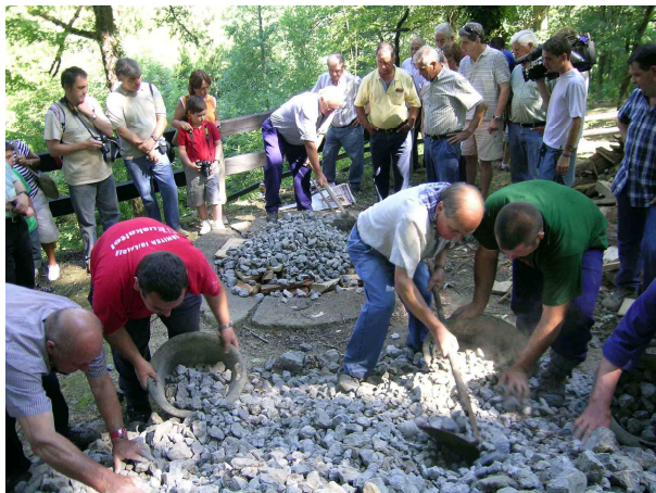
Antes del encendido hay que cargar el calero de madera y piedra caliza
