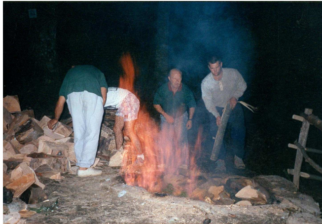
El fuego calcinará la piedra caliza y la transformará en cal viva
